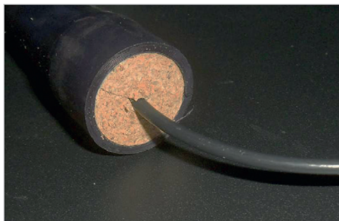
Foto 1. Ejemplo práctico de paso de coaxial impermeabilizado con un Suberino
