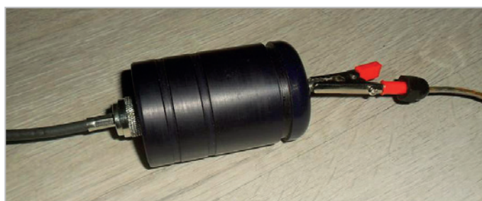
Foto 2. Modelo práctico de carga radiante CR666 operativa y conectada a un elemento radiante aleatorio
