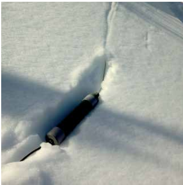
Antena de suelo desplegada en terreno nevado
