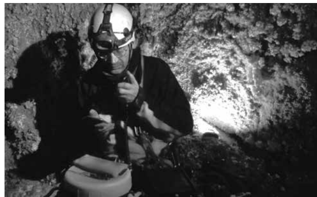
Ensayo de comunicaciones cavidad-superficie en Onda Corta
