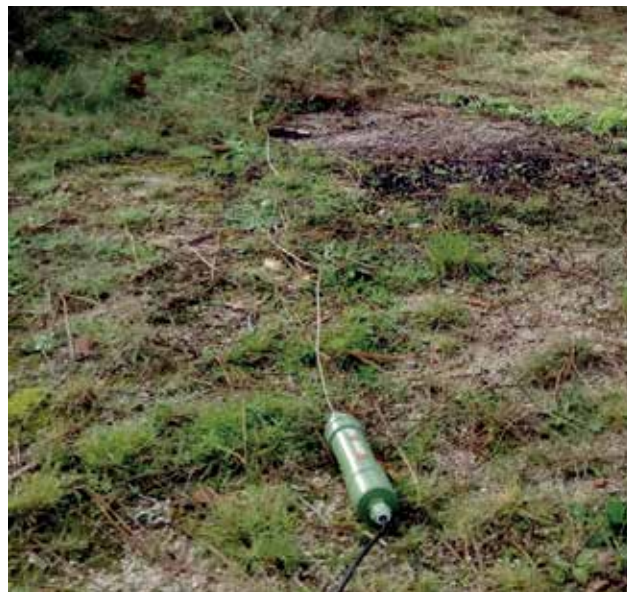
Prototipo 100 % waterproof WormAnt D 10-11-12 "SEAL", para investigar comunicaciones subterráneas en bandas de 10, 11 y 12 m
