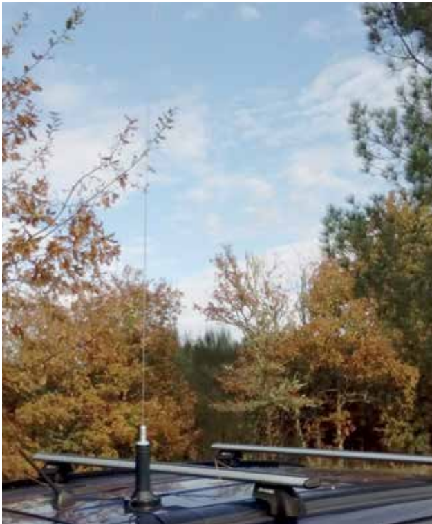
Prototipo WormAnt "TMC" D40 para montaje en vehículo
