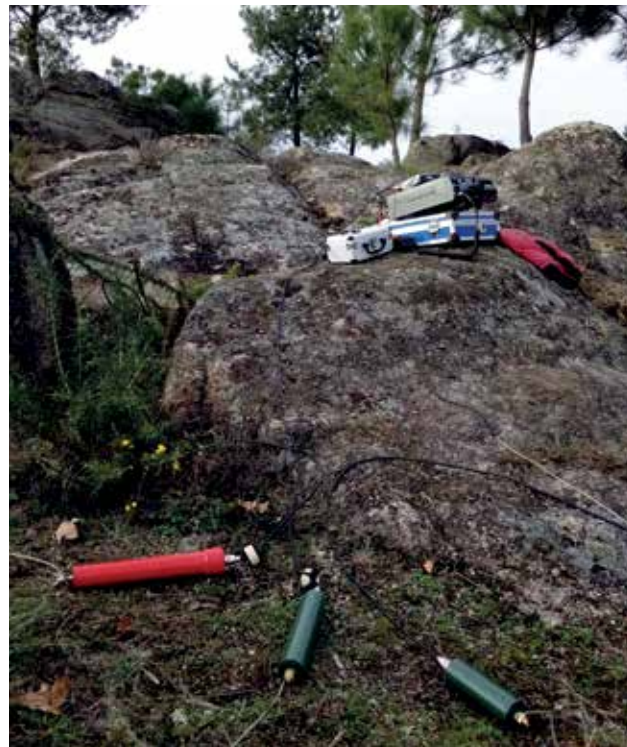
Testeando directividad con tres prototipos de antena de suelo en actividad de campo
